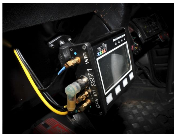
ここで、25mm ゴムボール台がロールケージの A ピラーバーに安全に付けられます。
