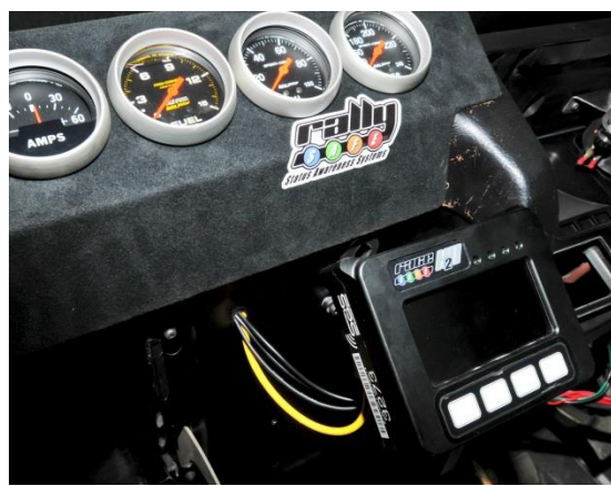
そして RallySafe ユニットが 25mm のゴムボール台に組立てられます (RallySafe コネクターから取付)。
