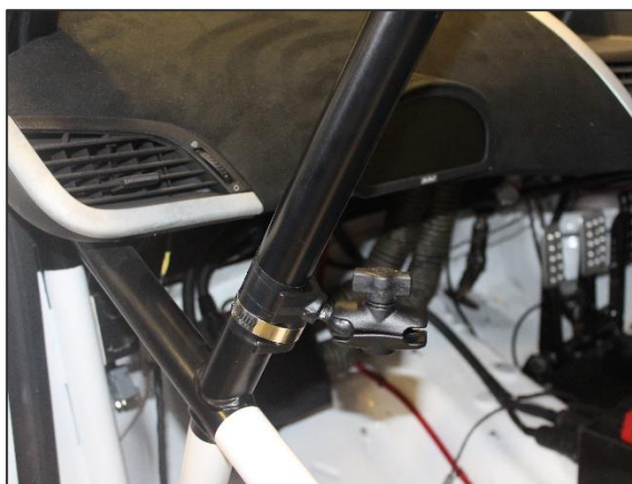
ここで、25mm ゴムボール台がロールケージの A ピラーバーに安全に付けられます。
