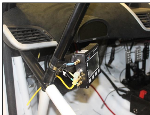
そして RallySafe ユニットが 25mm のゴムボール台に組立てられます (RallySafe コネクターから取付)。
