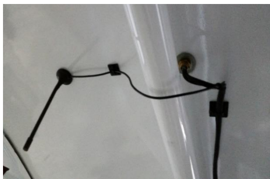
ここでアンテナを屋根の内部中央に貼り付けます(推奨)
